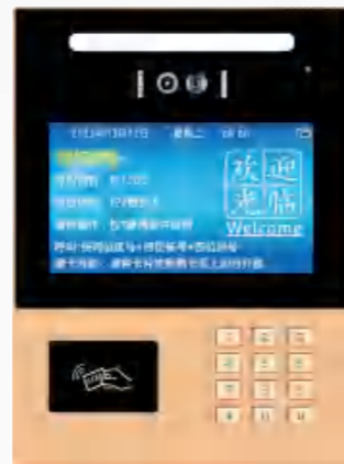
S101-1X9 10.1寸轻触按键人脸识别主机 外观尺寸：385×285×60mm 安装尺寸：370×273×45mm
